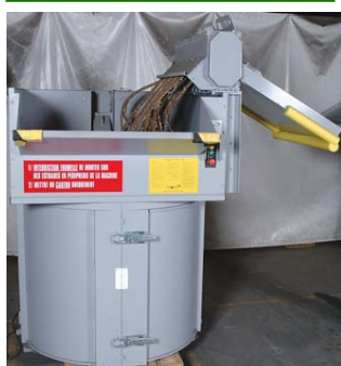
Předdrtič na velké kartony o šířce do 1200 mm a tloušťce 70 mm
