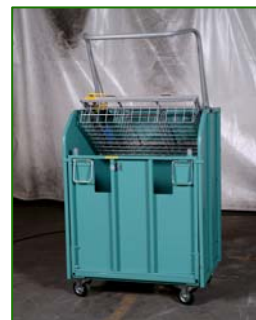
Pro lisování malého množství plastů Hmotnost balíku: max 40 kg
